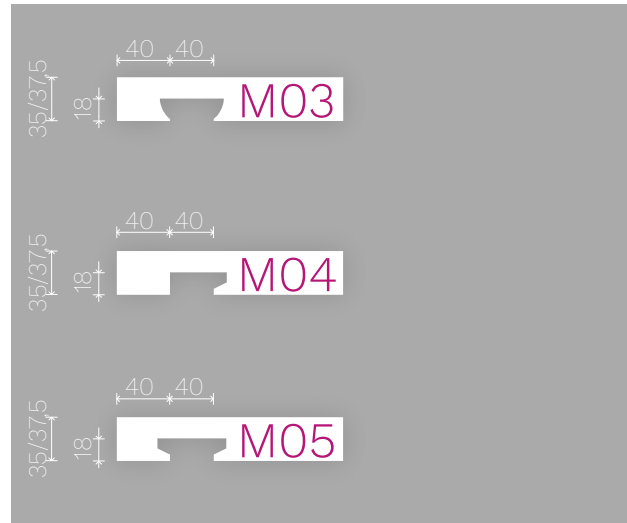
SEZIONI MANIGLIA SECTION OF BUILT-IN HANDLE
