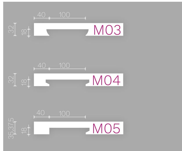
SEZIONI MANIGLIA SECTION OF BUILT-IN HANDLE
