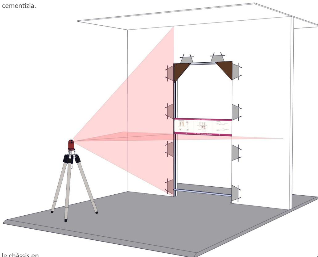
**3** Positionner le châssis en aluminium avec l'aide d'un niveau laser, qui va permettre de respecter le niveau du plancher accompli, garanti que le châssis soit perpendiculaire au mur et qu'il soit carré avec le plancher. Procéder avec la fixation des agrafes d'acier du châssis avec mortier de ciment
