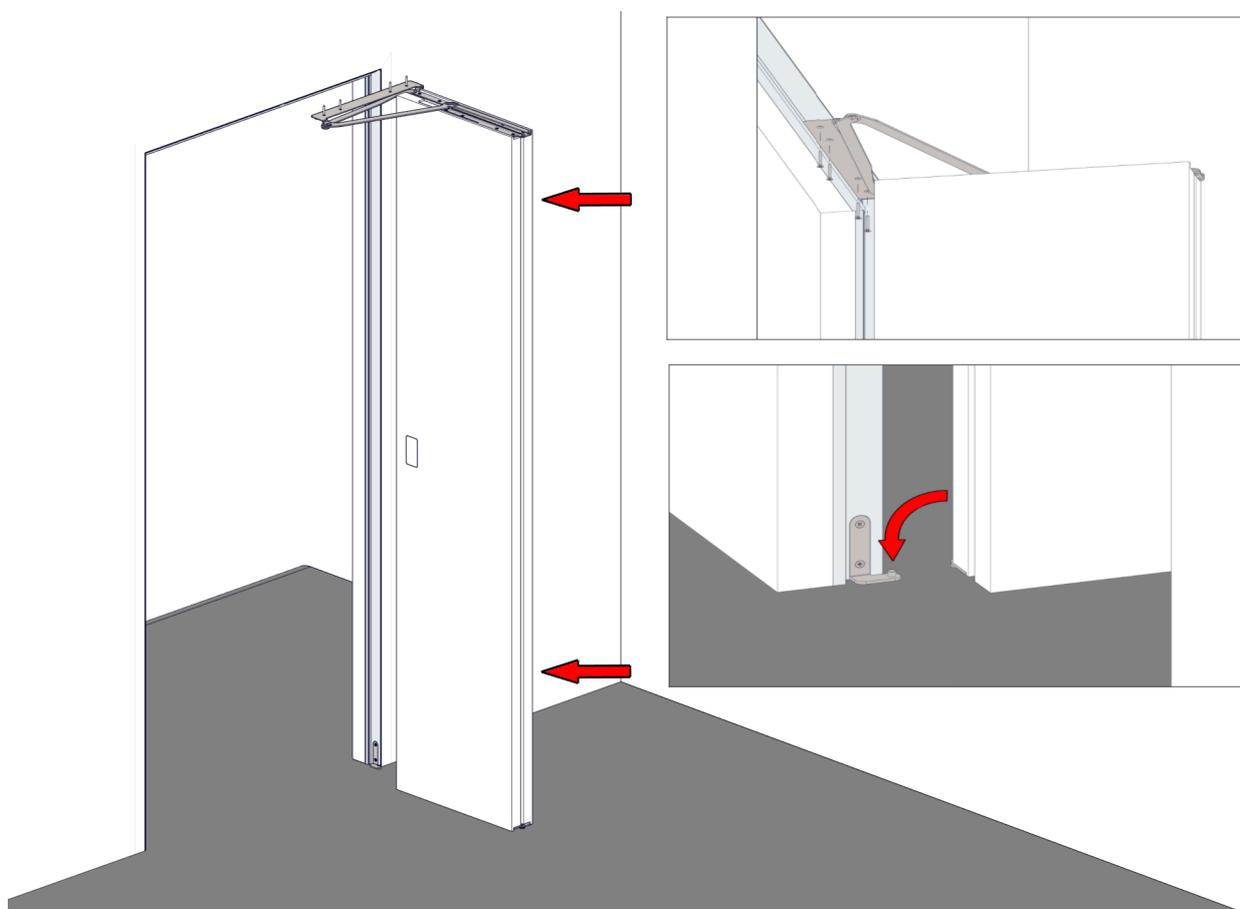
**4** Plier les deux panneaux et insérer le panneau dans l'axe de la charnière en bas. Positionner la quincaillerie supérieure et la fixer avec les vis disponibles.
