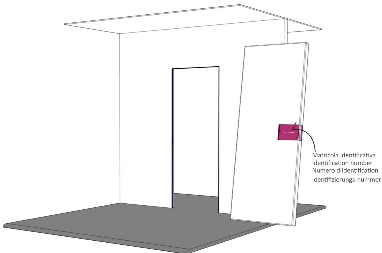
**1** Il faut se assurer que les panneaux qu'on est en train d'installer correspondent au châssis déjà installé, avec l'aide du numéro d'identification imprimé sur la partie en bas du panneau-même et sur l'emballage correspondant au panneau à installer.
