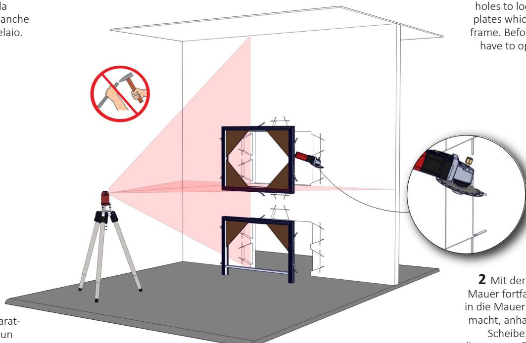
**2** Mit der Vorbereitung der Mauer fortfahren, indem man in die Mauer einige Öffnungen macht, anhand einer flexiblen Scheibe. Diese Öffnungen dienen zum Einsatz der auf der Zarge vorhandenen Lochgitterstreifen; vor deren Einsatz, müssen die Lochgitterstreifen geöffnet werden.
