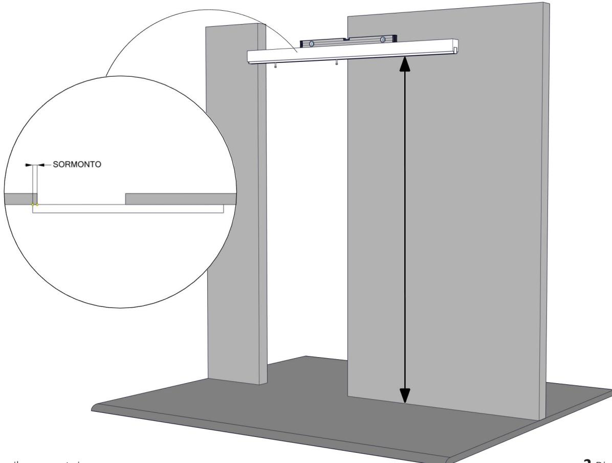
**2** Fixer le rail au mur et si nécessaire au plafond, en utilisant un niveau à bulle d'air pour garantir la planarité et avec l'aide des instructions fournies avec la porte .
