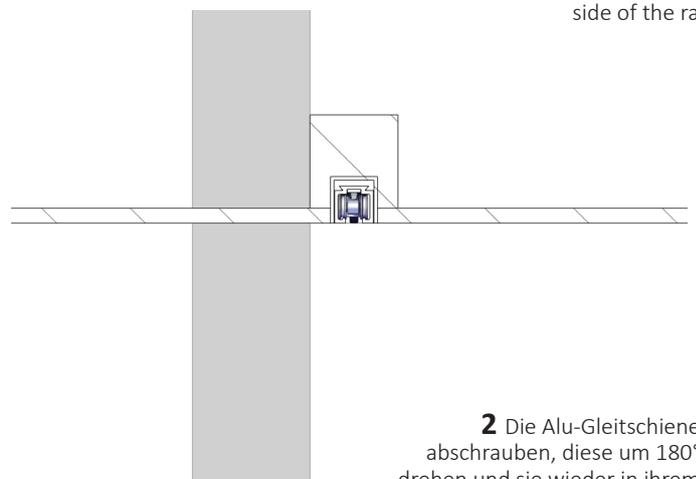
**2** Die Alu-Gleitschiene abschrauben, diese um 180° drehen und sie wieder in ihrem Sitz planar positionieren. Zur Regulierung helfen auch die vorhandenen Schrauben, die sich in der Gleitschiene selbst befinden.
