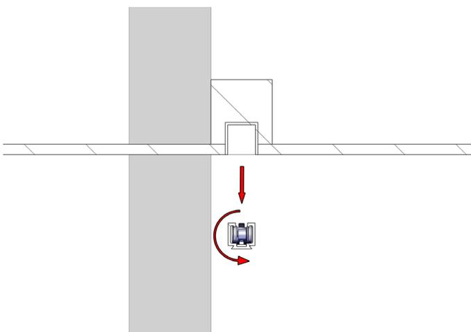
**2** Démonter le rail en aluminium, le tourner de 180° et l'insérer de nouveau dans son siège avec l'aide des vis de réglage que sont dedans le rail.
