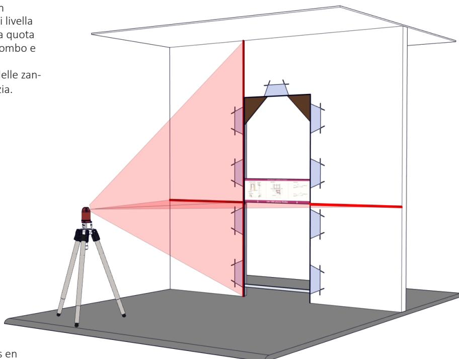
**3** Positionner le châssis en aluminium avec l'aide d'un niveau laser, qui va permettre de respecter le niveau du plancher accompli, garanti que le châssis soit perpendiculaire au mur et qu'il soit carré avec le plancher . Procéder avec la fixation des agrafes d'acier du châssis avec mortier de ciment
