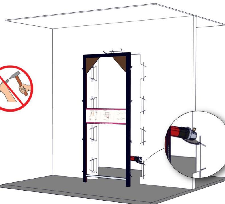
**2** Procéder avec la préparation du mur, avec l'aide d'un disque flexible; il faut faire des boutonnières où ensuite iront s'insérer les agrafes fixées au châssis. Avant on doit ouvrir les agrafes.
