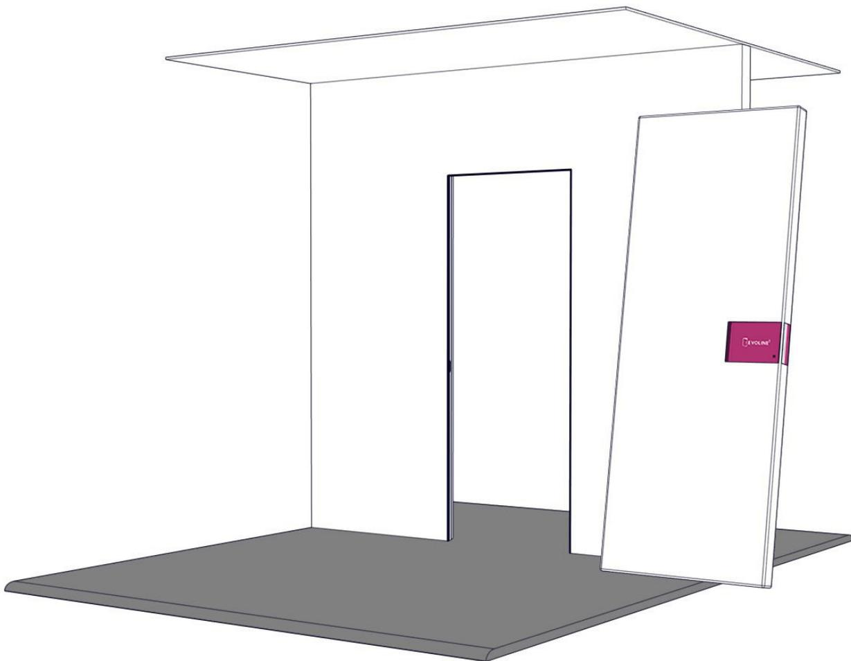
**1** Il faut se assurer que le panneau qu'on est en train d' installer correspond au châssis déjà installé, avec l'aide du numéro d'identification imprimé sur la partie en bas du panneau-même et sur l'emballage correspondant au panneau à installer.
