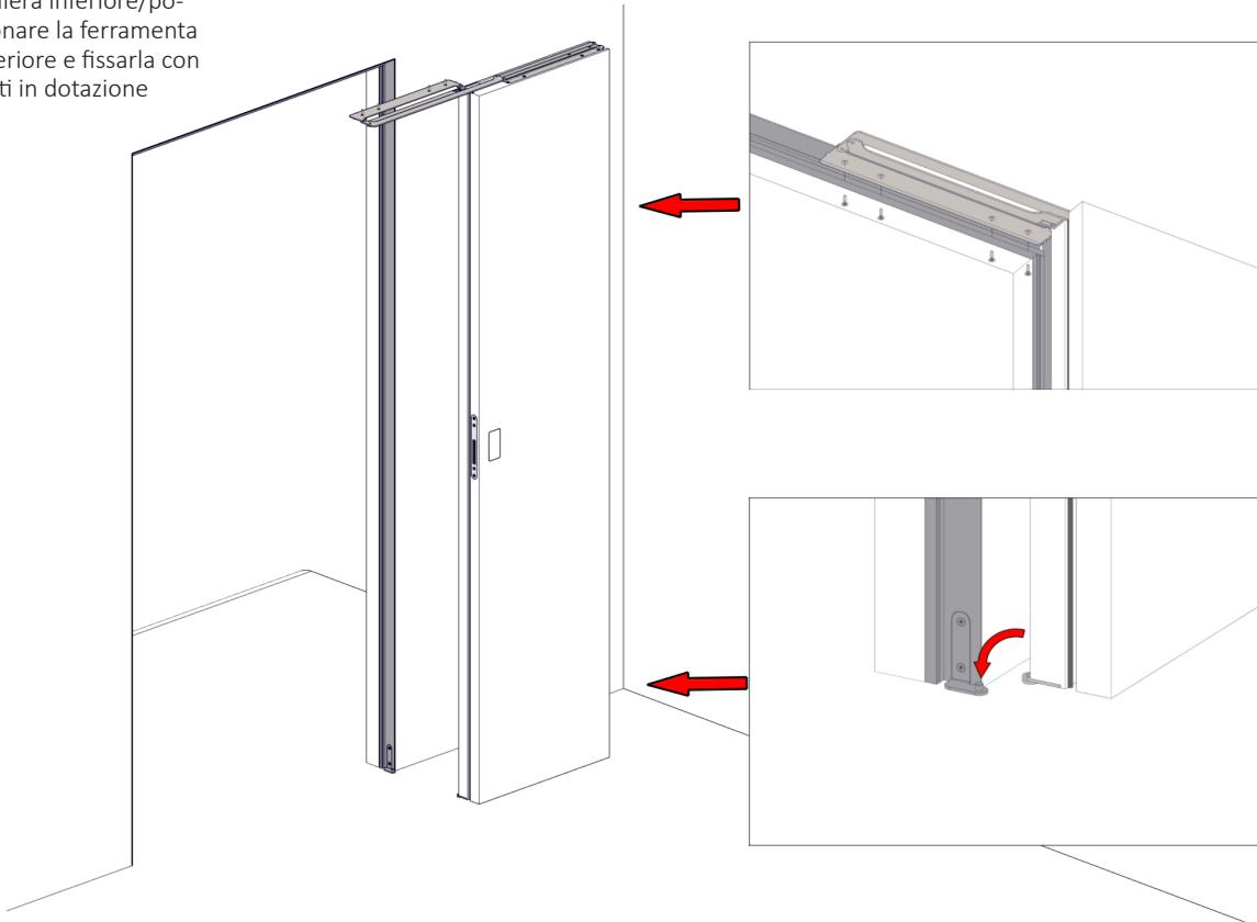
**4** Plier les deux panneaux et insérer le panneau dans l'axe de la charnière en bas. Positionner la quincallerie supérieure et la fixer avec les vis disponibles.
