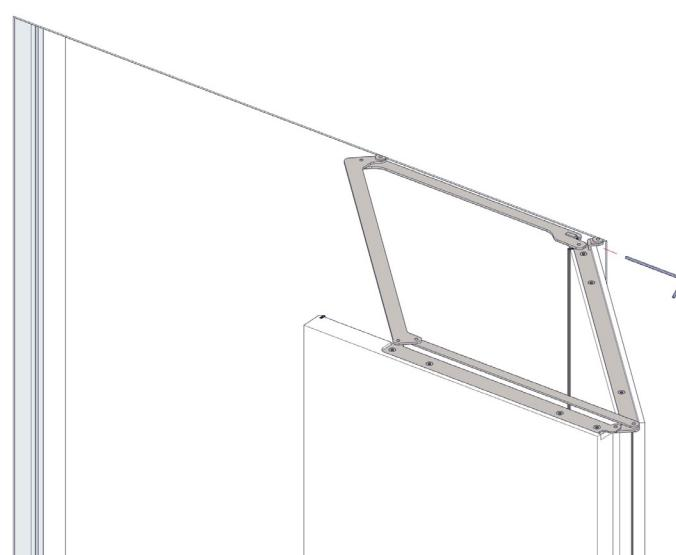
**4** Die zwei Türblätter falten; das Türblatt in der Achse des unteren Türbandes einstecken; der obere Beschlag positionieren und es mit den vorhandenen Schrauben befestigen .
